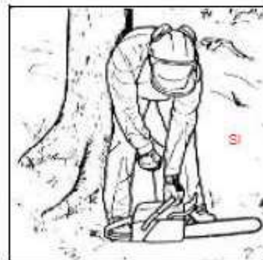
Posizione di avvio corretta A TERRA CON FRENO CATENA AZIONATO
