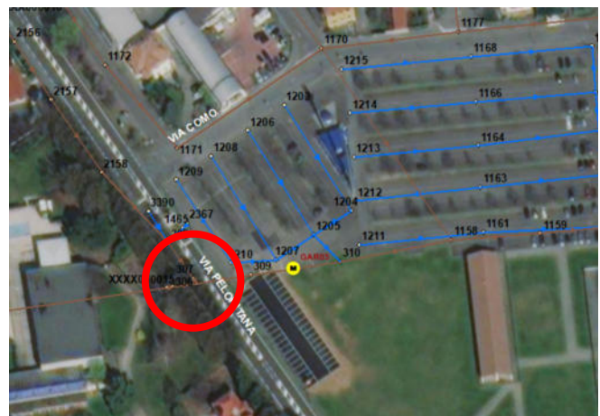
Figura 26: Mappatura criticità idrauliche Tr = 100 anni del punto critico Po23, Via Peloritana (criticità per Tr 100 anni)
