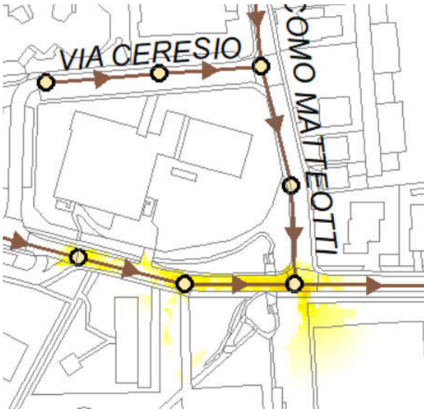
Figura 24: Mappatura criticità idrauliche Tr = 100 anni del punto critico Po21, Via Giacomo Matteotti incrocio dia Don Primo Mazzolari (criticità per Tr 50 e 100 anni)
