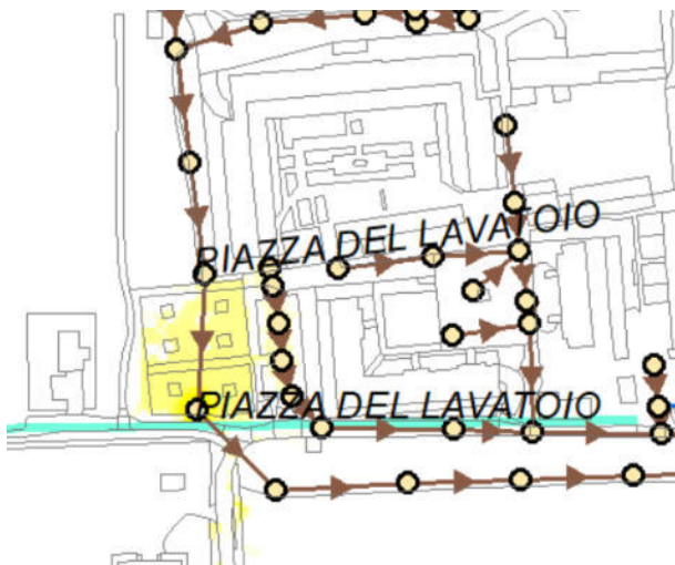
Figura 23: Mappatura criticità idrauliche Tr = 100 anni del punto critico Po20, Piazza del Lavatoio (criticità per Tr 50 e 100 anni)
