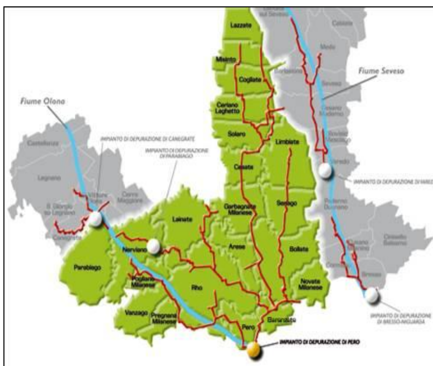
Figura B.26 - Il bacino di collettamento fognario che viene depurato nell'impianto di Pero Fonte: Sito internet I.A.NO.MI S.p.A.
