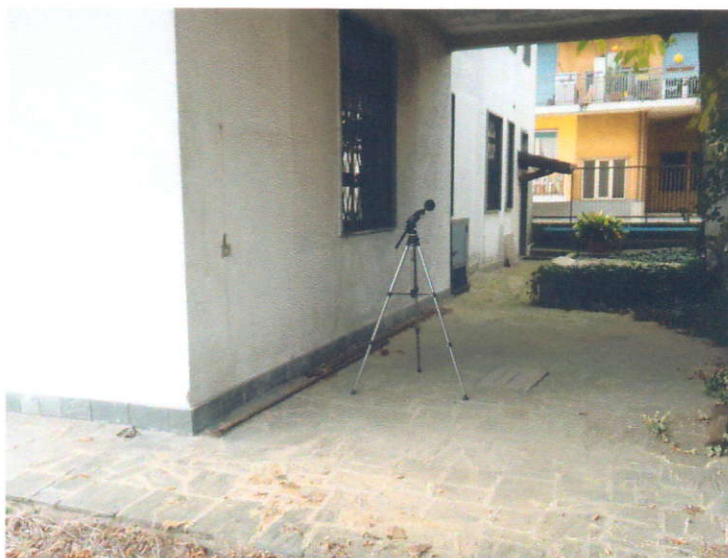
Foto 7: foto del posizionamento del fonometro all'interno dell'area in oggetto
